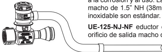
**UE-125-NF** eductor en línea de 1.5" NH (38mm) –con capacidad de flujo de 125 gpm. Aluminio anodizado de cubierta dura y de bajo peso para máxima resistencia a la corrosión y al uso. La entrada giratoria de 1.5" NH (38mm), el orificio de salida macho de 1.5" NH (38mm) y la manguera extra larga de 36" con barra de acero inoxidable son estándar.
