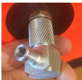
2. Enroscar el nuevo racor, en sentido horario.
