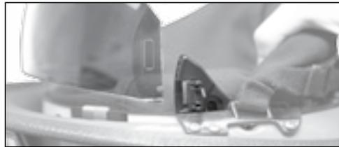
5) Coloque la lente en el dispositivo de retención; la hendidura debe coincidir con la pieza de acople dentro del dispositivo de retención.
