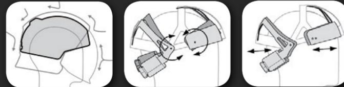
La forma en que la plataforma del casco, la cubierta externa el visor interactúan entre sí, logran sellar la cubierta externa contra todos los riesgos. Ningún casco similar ofrece protección cercana contra el calor, las llamas, las chispas y/o fluidos como el Magma.
