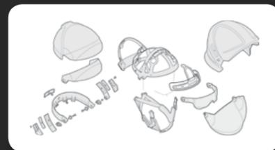
El casco es compatible con todas las piezas faciales del mercado, ya sean tipo araña de ajuste a la cabeza o de dos puntos de acople tipo europeo.
